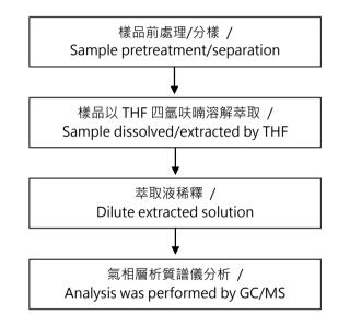
【測試方法/Test method: IEC 62321-8】
